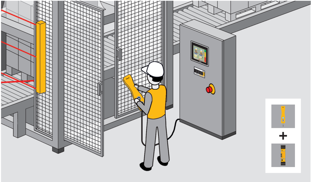
De optimale oplossing: tweehandenbewaking met het handbediend bedieningsapparaat PITjog en het veiligheidsrelais PNOZ s6.
