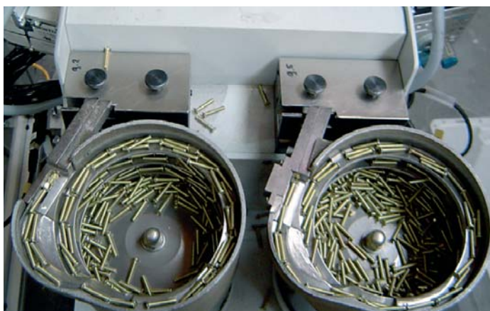
De machine beschikt over twee trilvullers waarmee de pneumatische schroevendraaier wordt gevuld. In de lader is tevens een inductieve sensor opgenomen die de aanwezigheid van de schroef detecteert.
