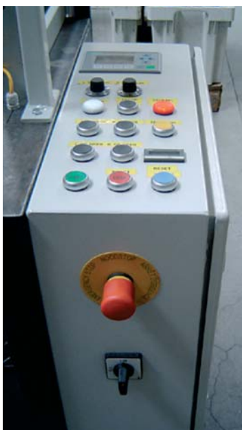
De besturingskast met diverse bedie- ningsknoppen en PNOZmulti Mini noodstop
