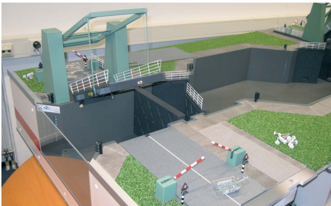
Maquette van een sluisencomplex aangesloten op echte PLC's om de brugbesturing uitvoerig te kunnen testen.
