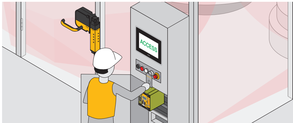
Authenticatie met PITreader card op een PMl visu-bedieningspaneel.
