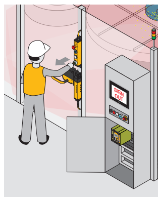
Sign out – invoer in veilige lijst van de Pilz besturing wordt verwijderd.
